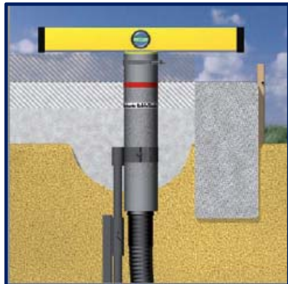
Rohbauelement vor Betonieren der Bodenplatte exakt ausrichten und unverschiebbar positionieren
