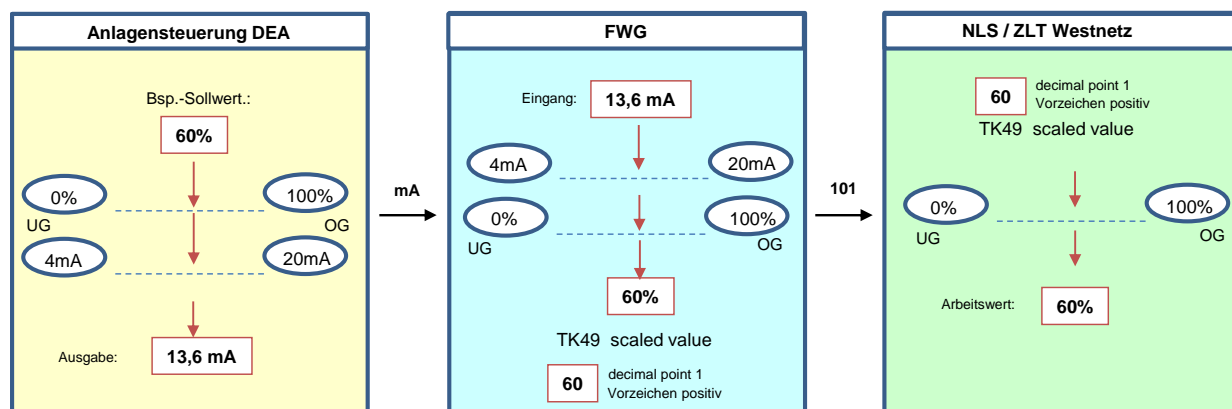
Abbildung 3: Wirkleistungs-Sollwertrückmeldung (gleitend)
